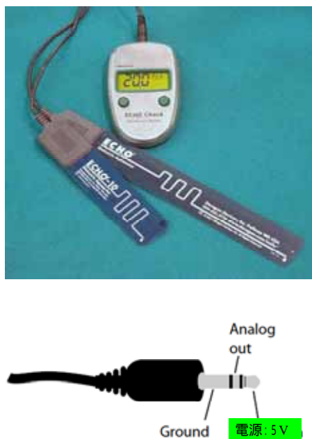
図10 ECH2O(キャパシタンス式土壤水分センサ)の結線を事実上の標準として採用
