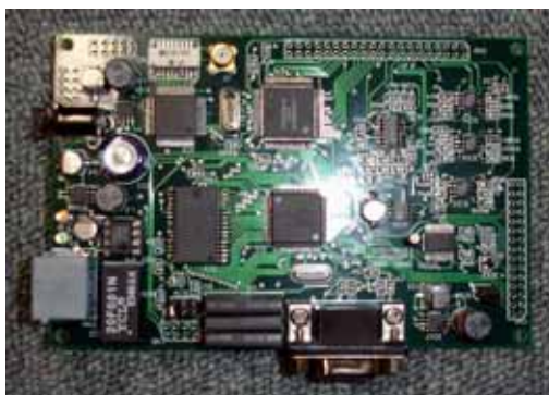
図11 FPAA搭載型フィールドサーバ・エンジンのプロトタイプ
