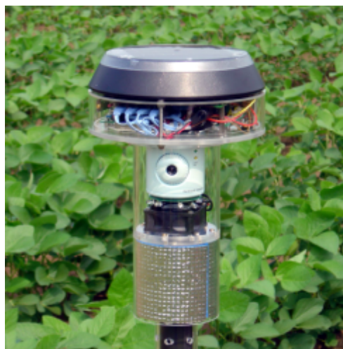
中央農業総合研究センターで開発された カメラを内蔵したフィールドサーバII・2004年夏モデル（研究・教育用）
