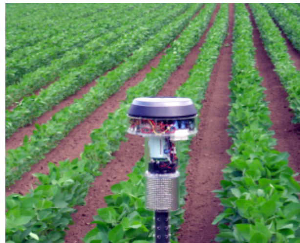
中央農業総合研究センターで開発された カメラを内蔵したフィールドサーバII・2004年夏モデル（研究・教育用）
