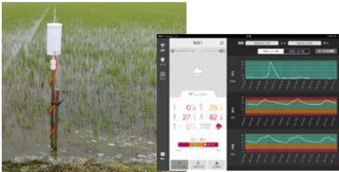
水田センサ：計測した水位、水温等をスマートフォン等で確認可能。（写真：㈱ベジタリア「Paddy Watch」）
