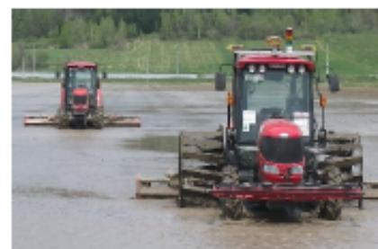
衛星測位データを基地局で補正することにより、高精度の自動走行を実現。 自動走行トラクターの無人運転の状況
