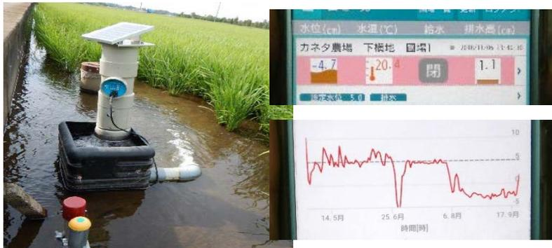
給排水の遠隔制御装置：給排水バルブに遠隔制御装置を装着し遠隔・自動で操作可能。（写真：㈱クボタケミックス「WATARAS」）
