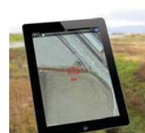
モバイル端末で破損箇所を地図上に記録し、破損状況を撮影。
