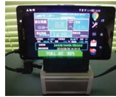
タブレット端末から雨量計や圧力水位計の情報を読み取り、農業水利施設の操作に活用
