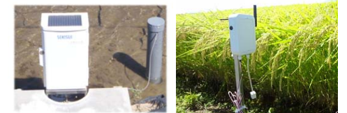
多機能型自動給水栓 水位センサ(水位・水温)
