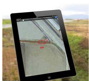
モバイル端末で破損箇所を地図に記録し、破損状況を撮影。
