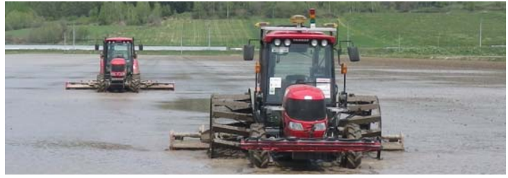
GPSガイダンスに連動する自動操舵システムの実証
