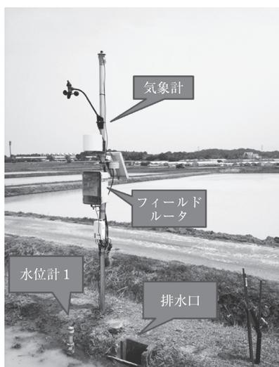
図-5 水田に設置されたモニタリング装置 (愛知用水土地改良区内)
